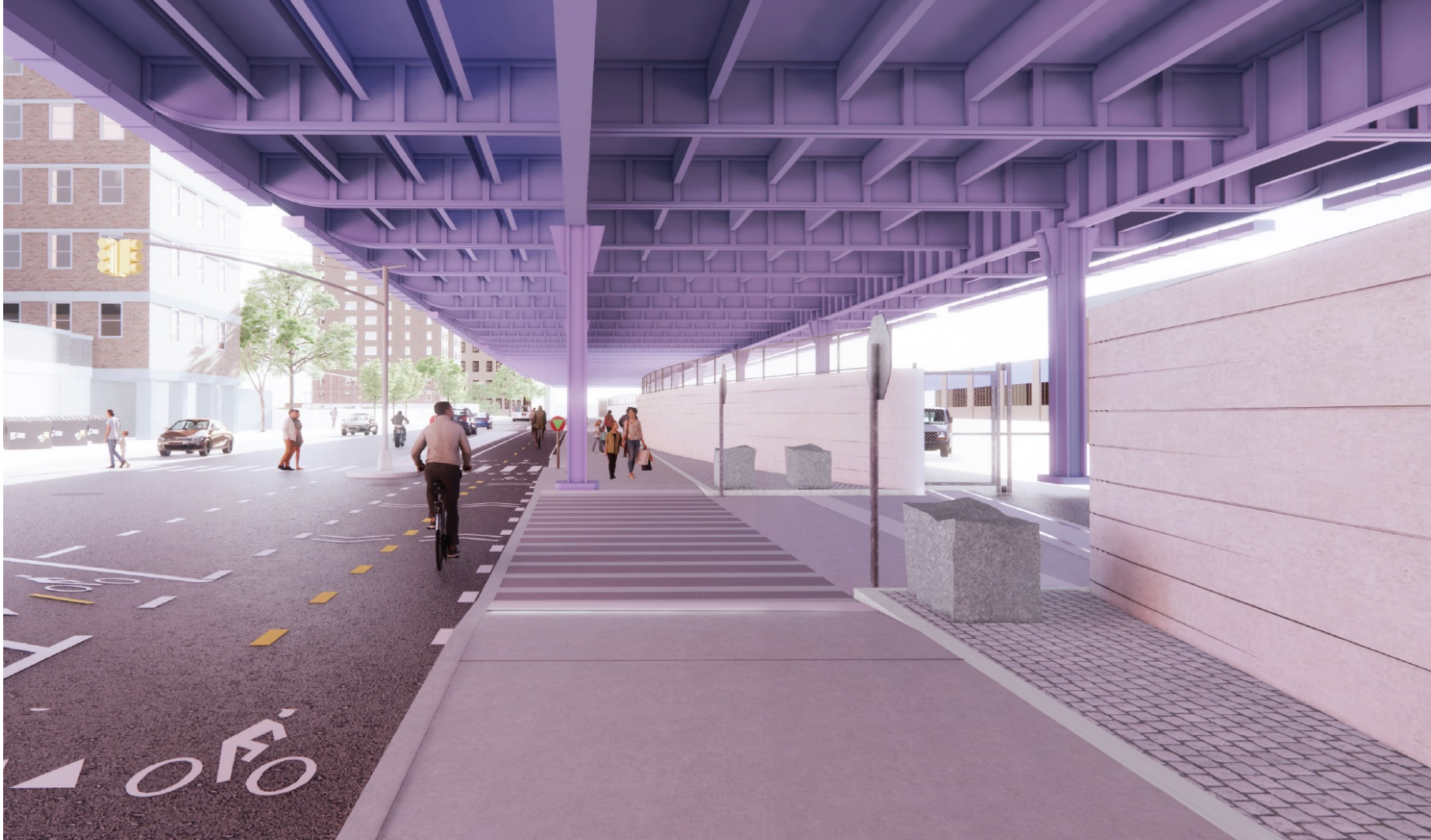
South街沿线在Clinton街和36号码头卫生部 (DSNY) 设施附近的固定防洪墙。
