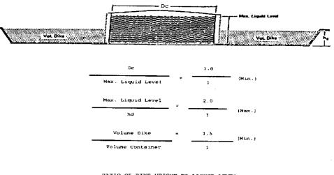
RATIO OF DIKE HEIGHT TO LIQUID LEVEL FIGURE 2
